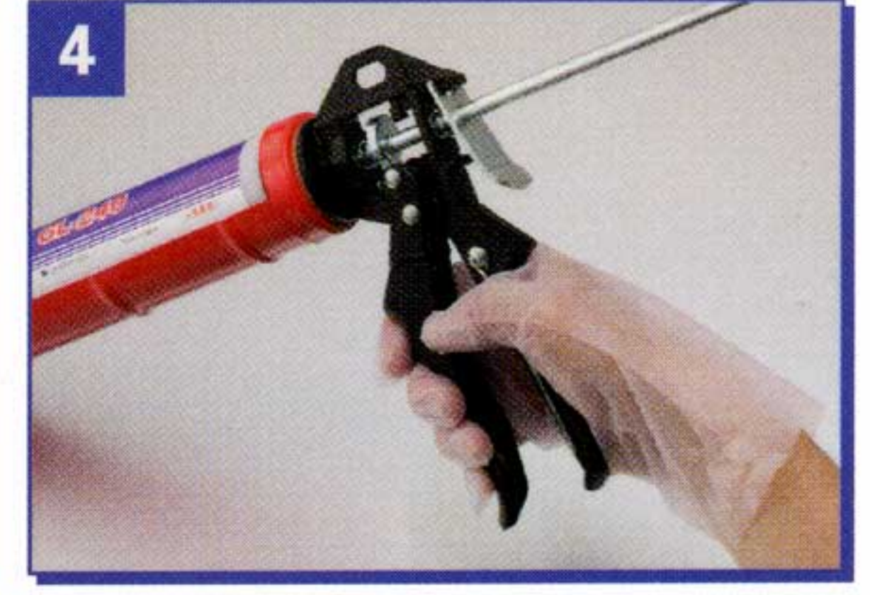
④ コーキングガンの引き金を引いて、ノズルの先から2液が出るまで押し出します。
